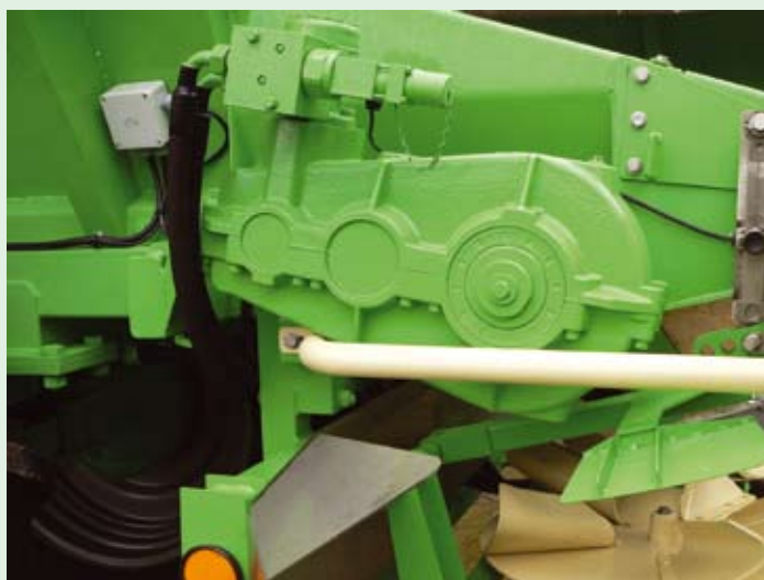
A kaparlóécs kihordó hajtóművének meghajtása. A megtett út arányában szeleppel szabályozza az adagolólánc sebességét.
