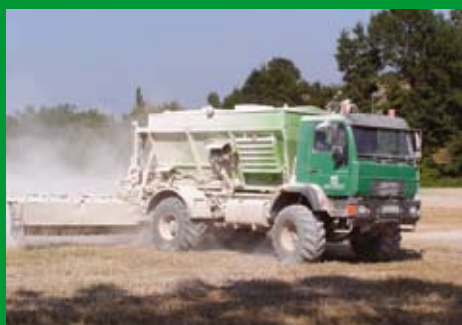
MAN a szóróegységgel és 8 m - es szórócsigás adapterrel.
