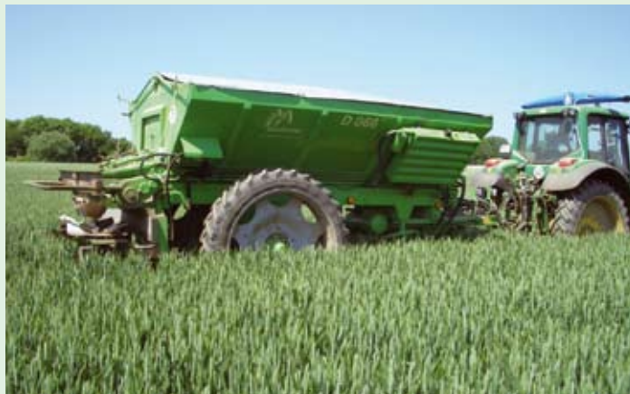
Elektro-hidraulikus szabályozású szántóföldi műtrágyaszóró üzem közben Yara-N-szenzorral.
