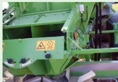
Hidraulikus működésű zárózsalu, szállításkor megakadályozza az elszóródást.
