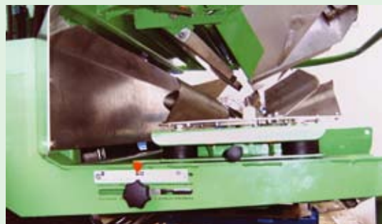
Szórószerkezet beállítása szerszám nélkül!
