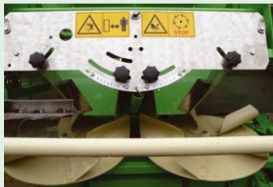
Az adagolási pont keresztirányú beállítása a terelőlemezzel.
