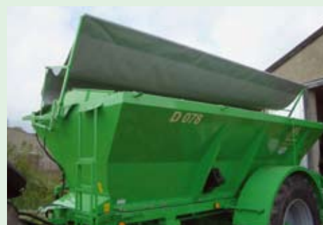
Hidraulikusan nyitható-zárható ponyva.
