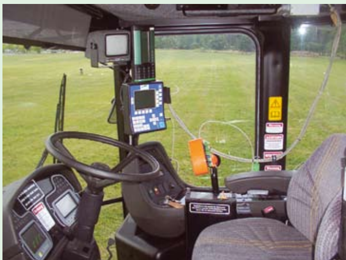
Fedélzeti számítógép széria felszerelésben más elektronikához kapcsolva (területspecifikus műtrágyázásnál).
